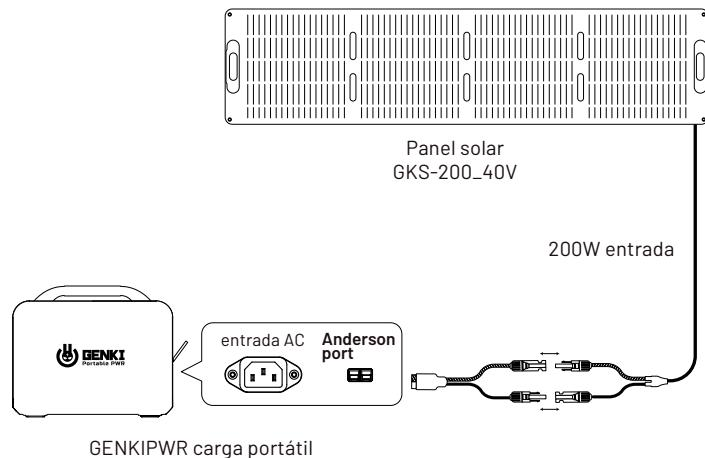
Forma de conexión de 2 paneles solares en equipos con entrada 11,5 a 50V
